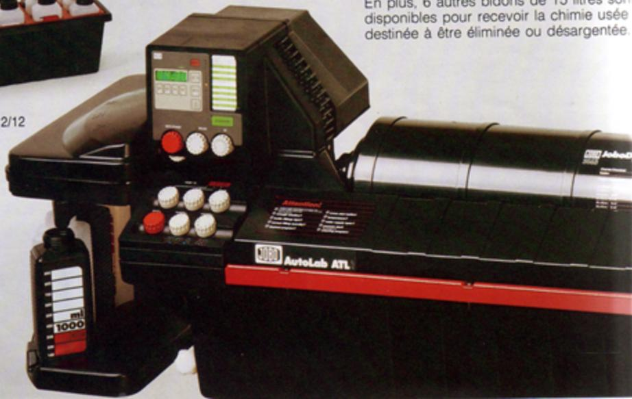
pour 4 procédés différents. L'alimentation automatique en chimie, à partir de grandes cuves de réserve, permet de traiter, par exemple, jusqu'à 270 films 35 mm avec un seul plein de machine.
