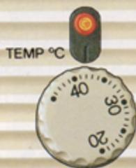
Cette machine garantit de grandes performances à un prix avantageux. Sur ce modèle, la température se règle et est maintenue constante par thermostat. La précision du réglage est de  $\pm 0,2^\circ\text{C}$  ( $0,36^\circ\text{F}$ ). Un voyant lumineux indique la phase de chauffage. La surveillance de la température se fait au moyen du thermomètre à mercure fourni.
